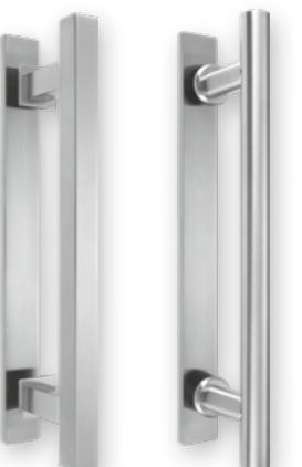
Varianten mit 10 mm Griffleiste in Ausführungen Länge 400 mm, 800 mm und 1200 mm in Edelstahl für Ganzglastüren erhältlich
